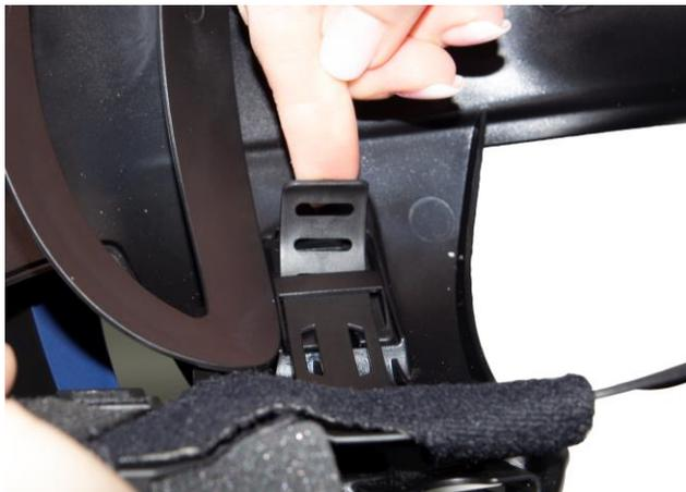
**10.2** Sichern Sie die beiden seitlichen Befestigungspunkte des Kopfgestells.
