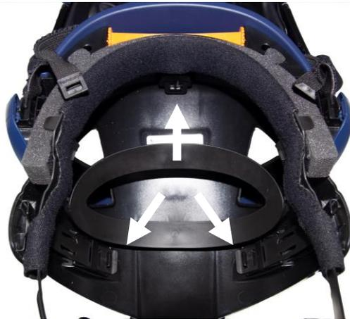
**9.1** Entfernen Sie das Kopfgestell vom Gesichtsschild, indem Sie die Verbindung an den drei Befestigungspunkten lösen. Nehmen Sie das Schweißband ab.
