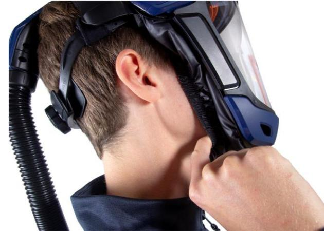
**4.3** Stecken Sie einen Finger zwischen Kinn und Gesichtsdichtung und führen Sie den Finger an der Kontaktoberfläche der Gesichtsdichtung entlang, bis sie gut am Gesicht anliegt.
