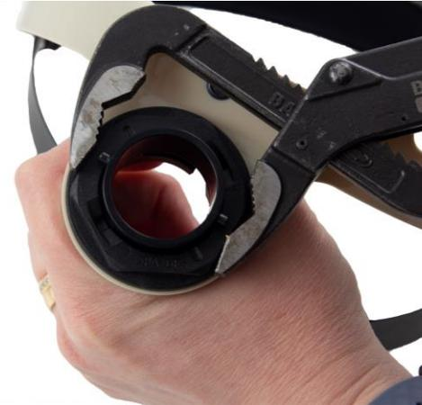
**7.3** Bauen Sie den neuen Schlauch in umgekehrter Reihenfolge in das Kopfgestell ein. Ein Schlauchanschluss verfügt über einen O-Ring. Dieses Ende muss am Gebläse/Druckluftzusatz angeschlossen sein.
