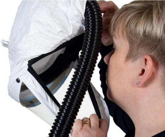
**3.1.** Greifen Sie den Schlauchanschluss mit einer Hand und den Halsbereich der Haube mit der anderen.
