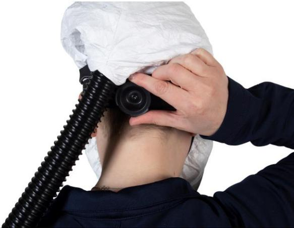
**3.4** Stellen Sie bei Bedarf den Umfang der Haube mittels des Knopfs rechts hinten am Kopfgestell ein. Der Knopf befindet sich an der Innenseite der Haube, unterhalb des Schlauchs. Er lässt sich jedoch von der Außenseite erreichen, ohne die Haube abzulegen. Drehen Sie den Knopf im Uhrzeigersinn, um den Umfang zu verkleinern und entgegen dem Uhrzeigersinn, um den Umfang zu vergrößern.
