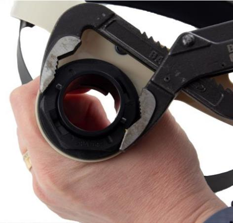
**7.3** Drehen Sie die Sicherungsmutter eine Vierteldrehung um es zu entfernen. Verwenden Sie eine Polygrip-Zange, wenn die Sicherungsmutter zum Drehen steif ist.
