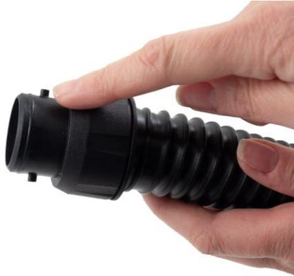
**1.1** Kontrolliere dass der O-ring des Schlauches richtig montiert ist.
