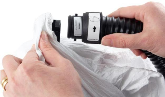
**6.3** Bauen Sie den neuen Schlauch in umgekehrter Reihenfolge in das Kopfgestell ein. Ein Schlauchanschluss verfügt über einen O-Ring. Dieses Ende muss am Gebläse/Druckluftzusatz angeschlossen sein.
