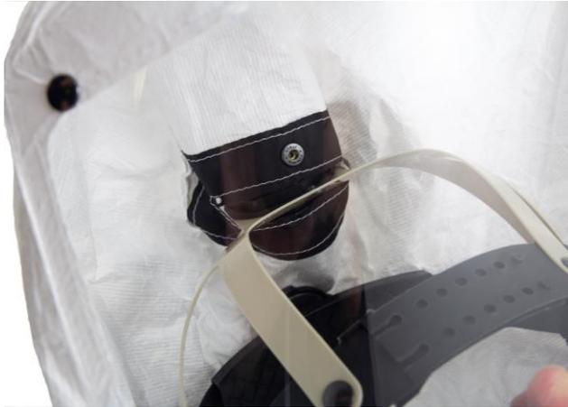
**5.5** Platzieren Sie den Adapter in den Luftkanal.
