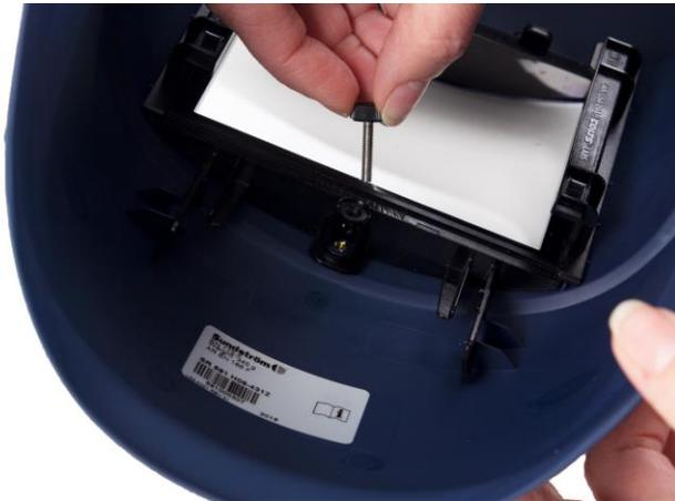
**5.1** Die Schraube in der Halterung für den Schweißfilter lösen.
