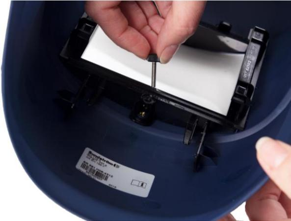
**6.1** Die Schraube in der Halterung für den Schweißerfilter lösen.
