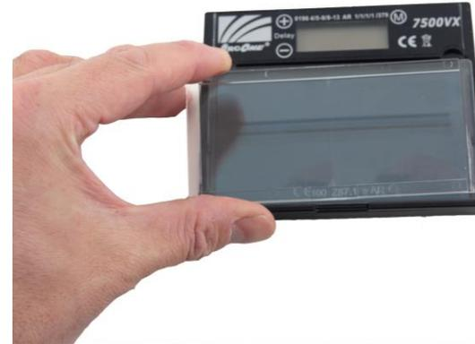
**5.3** Das neue Korrektionsglas an der Innenseite des Schweißfilters einsetzen.
