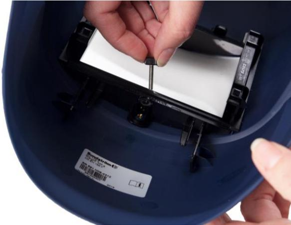
**4.1** Die Schraube in der Halterung für den Schweißfilter lösen.
